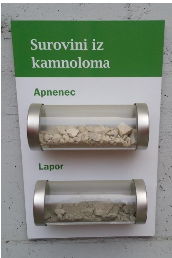
Za cement je potreben apnenec, lapor, žindra in klinker
